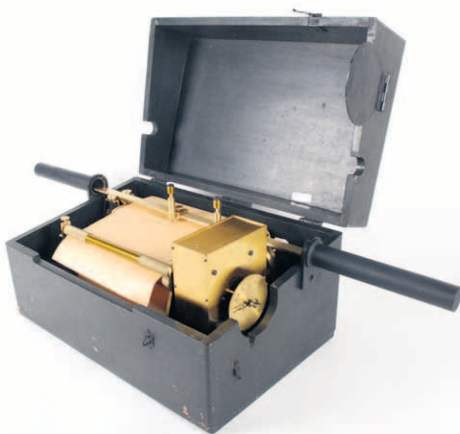
Limnimètre enregistreur portatif de Sarasin.
